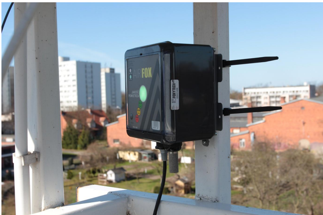
Fot. 1 Urządzenie AIRFOX Foxytech na stanowisku pomiarowym; na dole urządzenia widoczna końcówka z sondą temperatury i wilgotności powietrza (fot. T. Sawiński)
